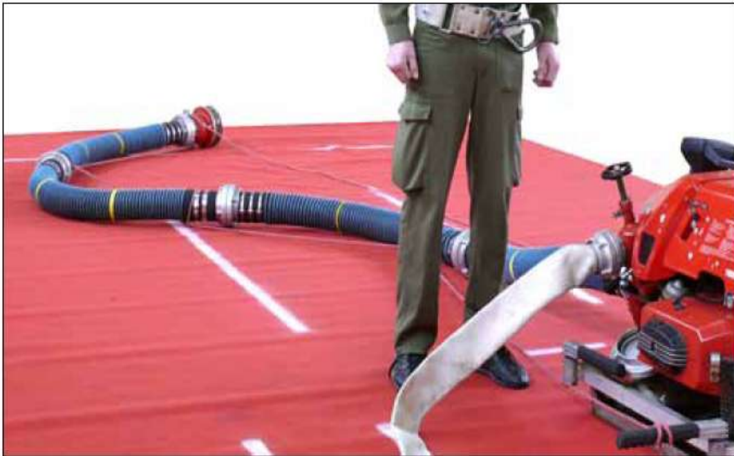
Abb. 16: Befestigen Saugschlauchleine an der TS
