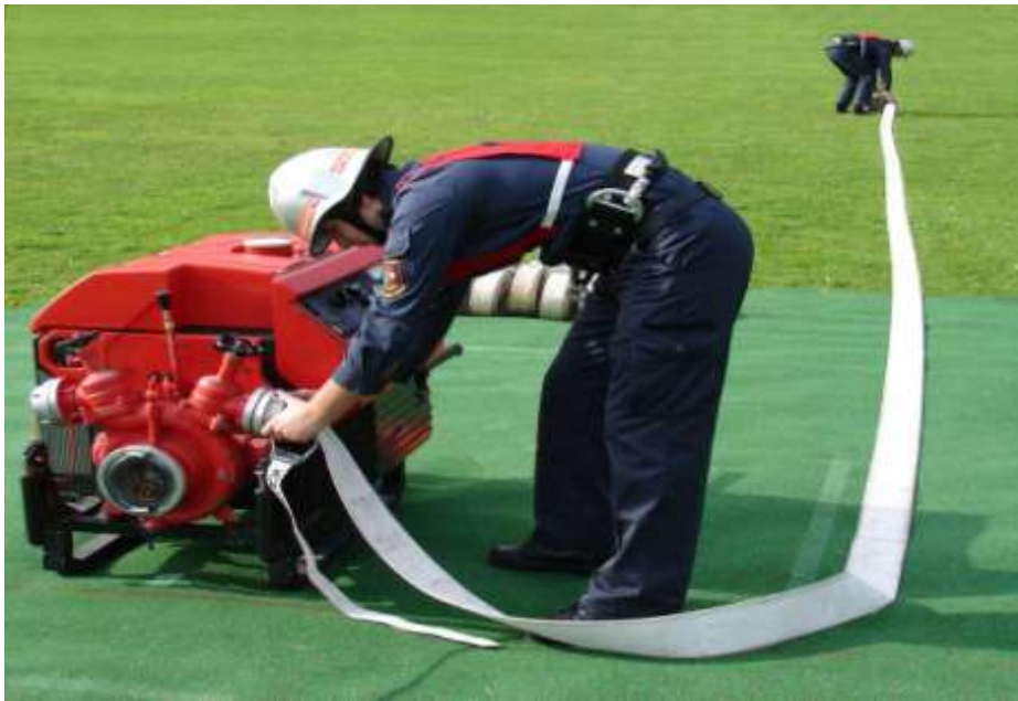
Abb.17: Ankuppeln und Auslegen des ersten B- Schlauches
