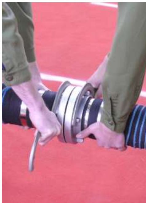
Abb.8b: Ansetzen der Kupplungsschlüssel und das Kuppeln der Saugschläuche
