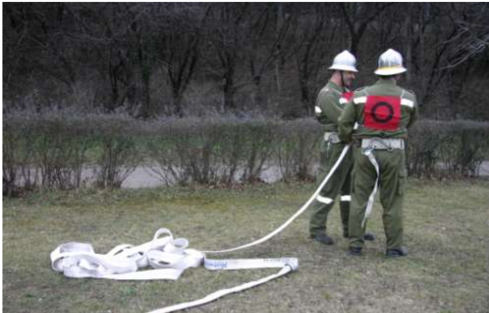
Abb. 21a Schlecht ausgelegter Druckschlauch „Haufen“
