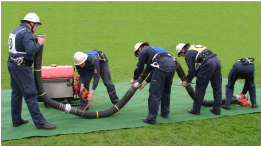
Abb.12: Tragen der Saugschlauchleitung Richtung Wasserentnahmestelle
